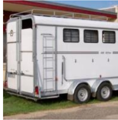
Dachreeling und Leiter.
