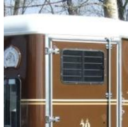
Schiebefenster 400x600 mm mit Sicherheitsglas und Schutzgitter.
