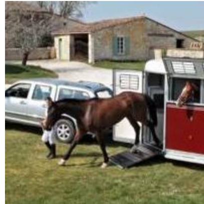
Vordere Entladerampe (anstelle der serienmäßigen Sicherheitstür).
