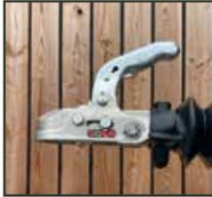
2. Tirer le loquet situé sous la tête de lapin vers l'avant d'une main et en même temps, avec l'autre main, appuyer sur le bouton et tirer la poignée vers le haut puis vers l'avant. Puis ensuite basculer la poignée vers l'arrière.
