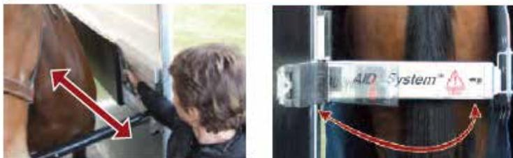
Remarque : L'Aid System™ permet une ouverture et fermeture du portillon depuis l'avant (avec une poignée située à l'avant contre la paroi intérieure du van) mais aussi depuis l'arrière (à l'aide d'une targette à ressort prévue à cet effet).
