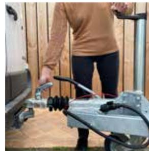
4. Baisser la tête sur la boule d'attelage en tournant la poignée de la roue jockey jusqu'à enclenchement total de la tête sur la boule d'attelage de votre véhicule.
