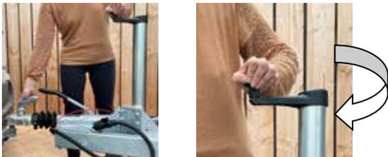
L'automatisme s'effectue grâce à un ergot (*photo 1*) qui bloque et relève la roulette totalement. Il faut que la roulette soit accolée à l'ergot pour partir en toute sécurité (*photo 2*).
