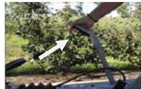
3. Enlever la prise électrique, la mettre sur le support de prise et retirer le câble de sécurité.
