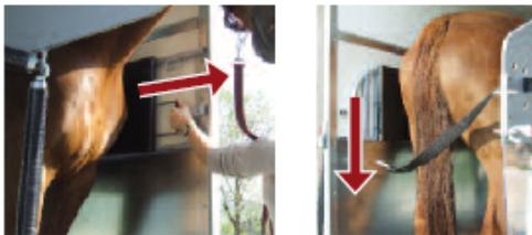
Si votre van est équipé de l'option Aid-System™, ouvrez le portillon à l'aide de la poignée située à l'avant et utilisez les arrêts de portes prévus pour maintenir les portes ouvertes.
