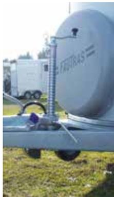
7. Accrocher le câble de sécurité sur le point fixe prévu sur l'attelage de la voiture (ce point fixe doit être dans l'axe du câble). L'utilisation de ce câble est obligatoire car il permet de stopper la remorque en cas de mauvais attelage de la remorque.
