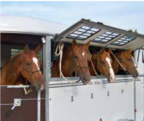
Ouverture latérale pour plus d'aération à l'arrêt.
