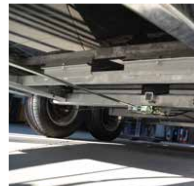
Suspensions à roues indépendantes et sans entretien, garantissent une excellente tenue de route.
