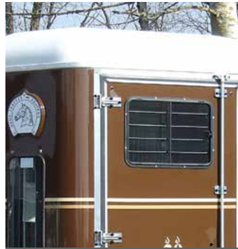
Baie coulissante latérale 400x600 mm en verre sécurit et grille de protection.
