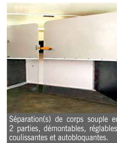
Plancher polyéthylène imputrescible et antibruit.
