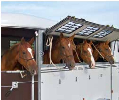
Ouverture latérale pour plus d'aération à l'arrêt.
